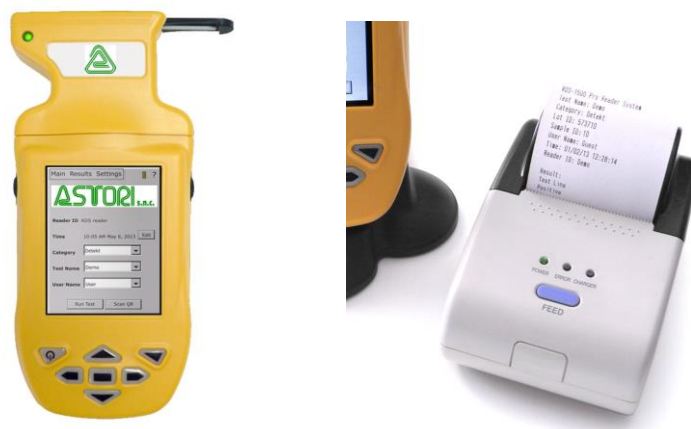
Figura 6: Lettore RDS-1500 PRO per l'interpretazione delle Strip Test e stampante opzionale
